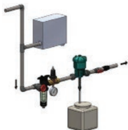
Instalación en línea de alimentación de tanque
